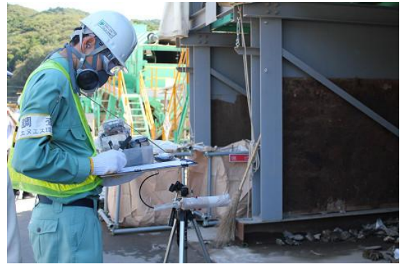
選別された廃棄物の放射能を測定している
