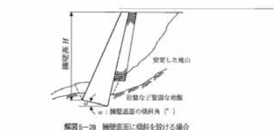
解説 5-28 擁壁底面に傾斜を設ける場合
