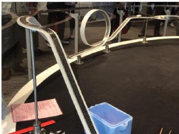
どきどきリニア館の2階の「超伝導コースター」。超伝導体を液体窒素で冷やして、磁石を敷き詰めたレール上を超伝導体が浮上してジェットコースターのように走る様子を実験して見せてくれた。この装置、総費用は200万円とのこと。
